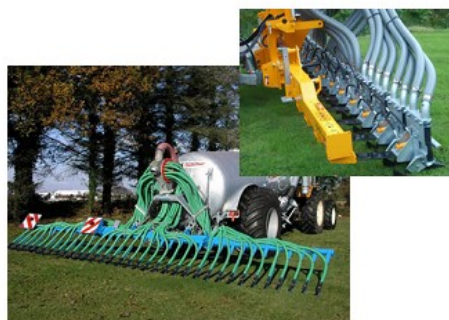
Figure 8: citerne avec rampe pendillard (à gauche), citerne avec rampe à patin + zoom sur les sabots (à droite)
